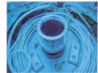
超音波式波高計(海底設置型)
