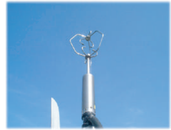
三次元超音波風向風速計
