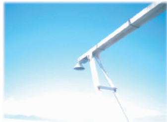
超音波式波高計(空中型)
