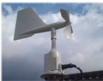
プロペラ式風向風速計
